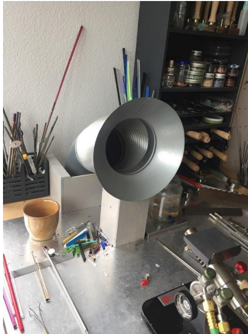
Abbildung 6: Abzug und hitzefeste Unterlage eines Glaskunst-Arbeitsplatzes
