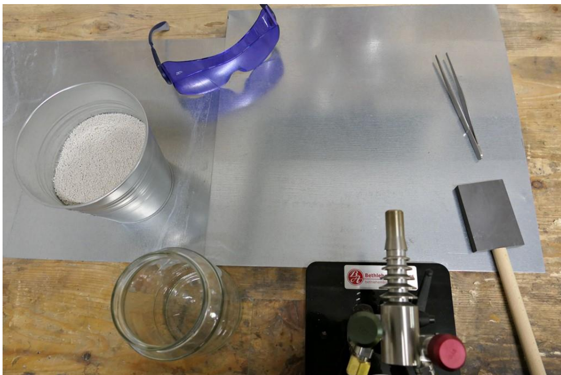
Abbildung 1: Typischer Glasperlen-Arbeitsplatz bestehend aus einem Gasbrenner, Schutzbrille, Granulat, Wasserglas, Graphit-Paddel und Pinzette
